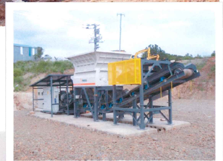
破砕機2（廃プラスチック類等） 処理能力：83.2t/日（8時間）
