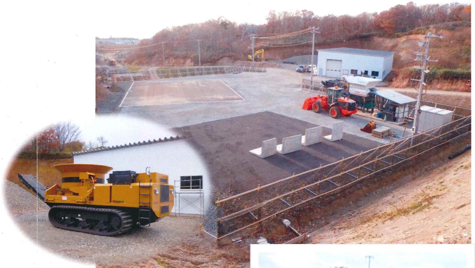
破砕機1（木くず等） 処理能力：175.32t/日（9時間）
